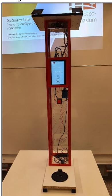
*Die smarte Laterne. Gut zu erkennen sind hier das Touchscreen Display, der Raspberry Pi im oberen Bereich sowie die gesamte Konstruktion mit den verbauten Bauteilen, dem Ladepad und der Elektronik.*
