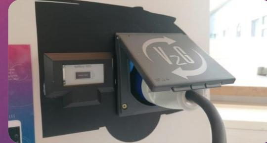
In unserem Projekt simulieren wir die Ladung bzw. Entladung des Akkus mithilfe eines kleinen E-Auto Modells. Die Entladung lässt sich über einen Taster einleiten. Der neue Akkustand wird vollautomatisch an die Wallbox geschickt, die den aktuellen Akkustand übernimmt. Am E-Auto Modell ist ebenfalls ein E-Paper-Display angebracht, welches die wichtigsten Parameter anzeigt.
